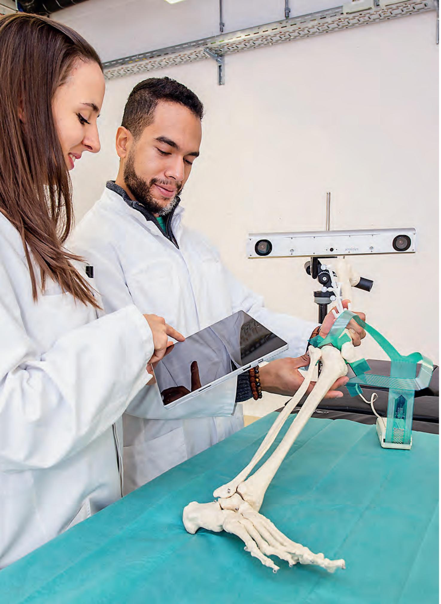
Erste Versuche am synthetischen Knochen. Das optische System erfasst die Bewegung der Knochen und die Drucksensoren quantifizieren den Druck im Kniegelenk.
