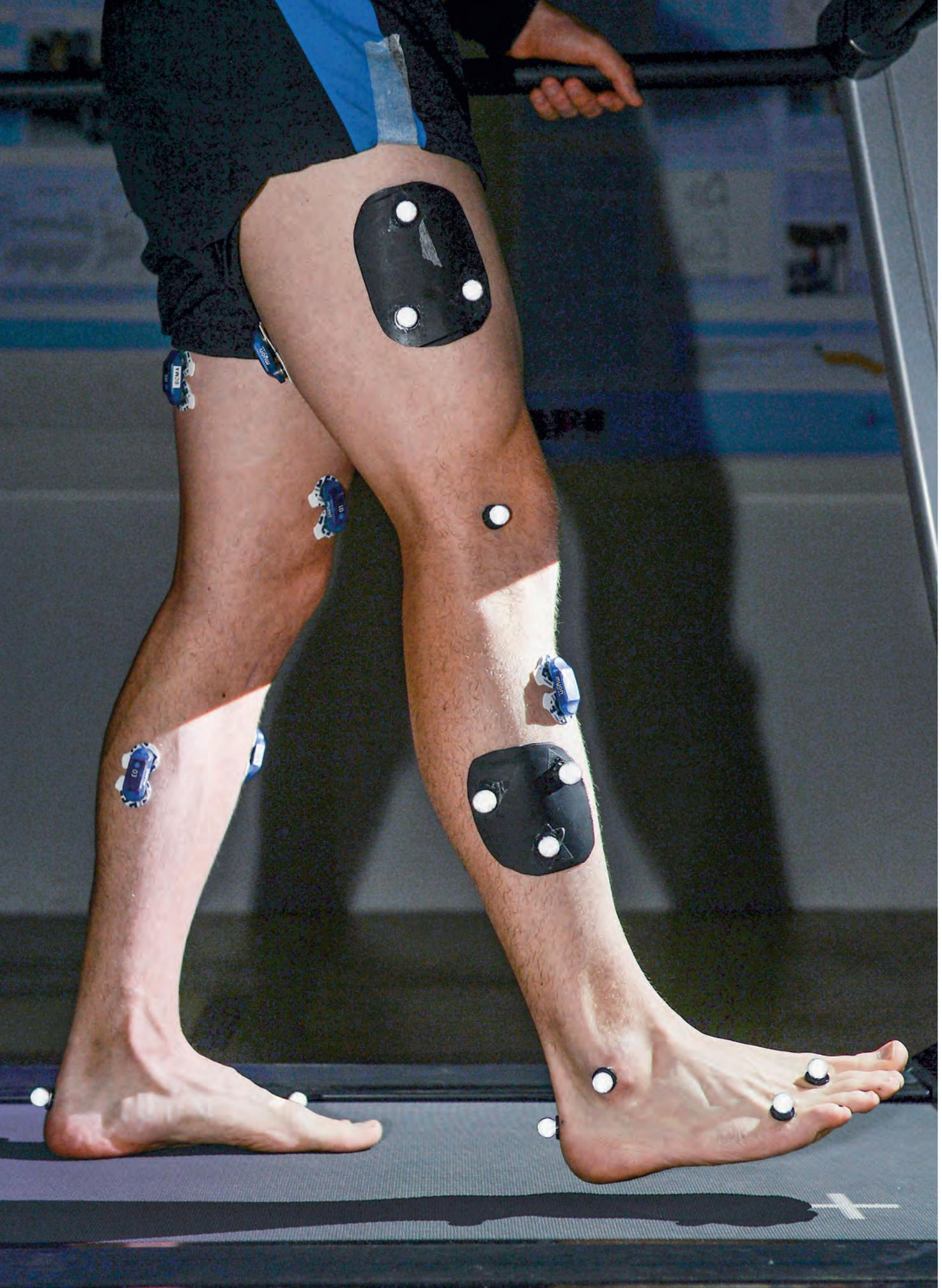
Kinematische Bewegungsanalyse mit simultaner Elektromyographie. Reflektierende Marker werden von Infrarotkameras detektiert und ermöglichen eine 3D-Analyse der Bewegung. Ein mobiles, elektromyographisches System zeichnet muskuläre Aktivitäten von verschiedenen Beinmuskeln auf.
