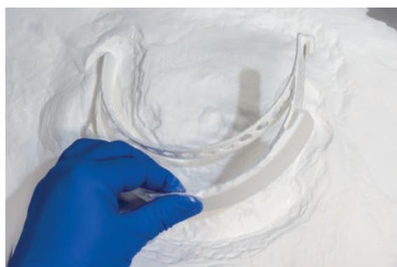
Die Grundhalterung für den Gesichtsschutz aus PA 2200 Polyamid steht nach dem Druckverfahren bereit für den nächsten Arbeitsschritt.
